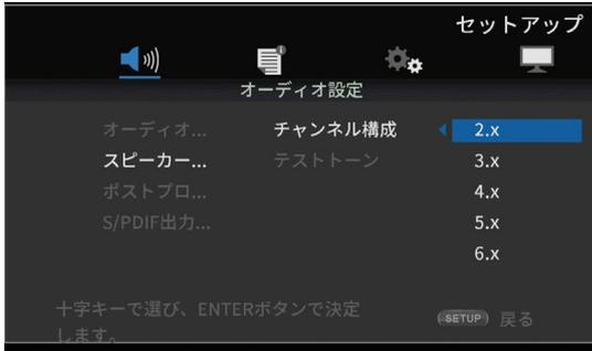
[>] カーソルボタン、または ENTER ボタンを押すと機能設定に移動します。[へ]/[v] カーソルボタンで使用するスピーカーの数を選択し、ENTER ボタンで決定します。
