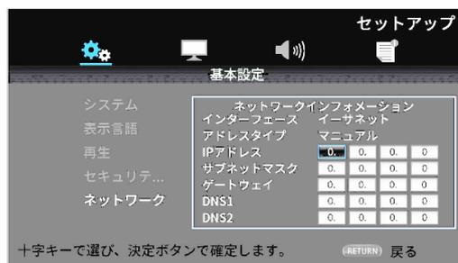
IP アドレス、サブネットマスク、デフォルトゲートウェイ、DNS1 および DNS2 の番号を数字ボタンで入力し、カーソルボタンで移動します。
