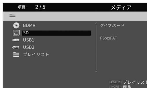
\* USB 番号はフロントパネルの USB 端子に接続した USB メモリーが USB1、リアパネルの USB 端子に接続した USB メモリーが USB2 として表示されます。
