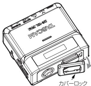
2. 端子カバーを抜いた後、AK-BT1 を本体に挿入する。
