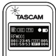
\* USB 充電器で充電中の場合、動作表示インジケーターは、録音 / 録音一時停止中に問わず、充電完了まで点滅します。
